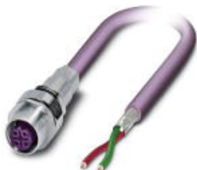
Bus-System-Einbaubuchse, PROFIBUS, 2-polig, M12, geschirmt, B-kodiert, Vorderwand-/Schraubmontage mit M16-Gewinde, positionierbar, mit 10 m Buskabel, 2x 0,25 mm 2
