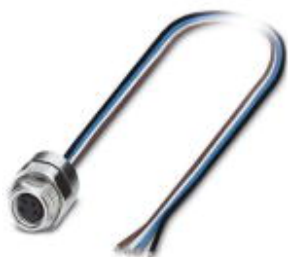
Sensor-/Aktor-Einbaubuchse, 4-polig, M8, Hinterwand-/Schraubmontage mit M12-Gewinde, mit 0,5 m TPE-Litze, 4 x 0,25 mm 2
