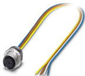
Bus-System-Einbaubuchse, PROFINET, 4-polig, M12-SPEEDCON, D-kodiert, Vorderwand-/Schraubmontage mit M16-Gewinde, mit 0,5 m TPE-Litze, 4x 0,34 mm 2
