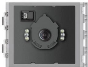
Night & Day-Farbkameramodul mit Weitwinkelobjektiv (135° Horizontal/96° Vertikal) zum Anschluss an das Audio-Türlautsprechermodul Plus Art. 351100 über das mitgelieferte Verbindungskabel. Die automatische N&D-Funktion aktiviert bei entsprechenden Lichtverhältnissen den mechanischen IR-Filter. Ausgestattet mit einem 1/3"-Sensor, IR-LED zur Beleuchtung des Aufnahmebereichs und Antibeschlag-Heizung (Heizwiderstand).
