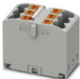
Verteilerblock, Grundklemme, Die Blöcke sind untereinander über den Leiterschacht brückbar. Passende Steckbrücken siehe Zubehör, Nennspannung: 450 V, Nennstrom: 24 A, Anschlussart: Push-in-Anschluss, Anzahl der Anschlüsse: 6, Querschnitt: 0,14 mm<sup>2</sup> - 4 mm<sup>2</sup>, AWG: 26 - 12, Breite: 16 mm, Höhe: 21,7 mm, Farbe: grau, Montageart: aufrasten auf Tragschienenadapter
